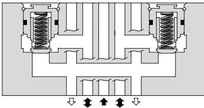
Das Anti Kavitationsventil ermöglicht das Nachsaugen von Öl um Kavitationsschäden zu vermeiden.
